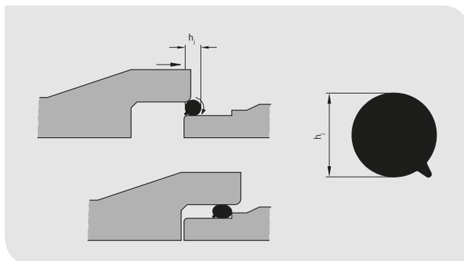
Die M.O.L. Betonrohrdichtung System MTR ist eine Rollringdichtung für Beton- und Stahlbetonrohre. Sie wird auf dem Spitzende des Rohres montiert und garantiert eine funktionssichere Verbindung nach DIN EN 1916 und DIN V 1201. Zudem erfüllt die MTR-Dichtung die Anforderung nach DIN EN 681-1.
